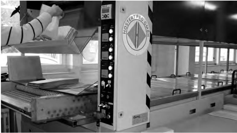
Konservierungsmaschine für die Massenentsäuerung von Archivgut im Archivcenter West der Abtei Brauweiler, LVR-AFZ, Foto privat 2009
