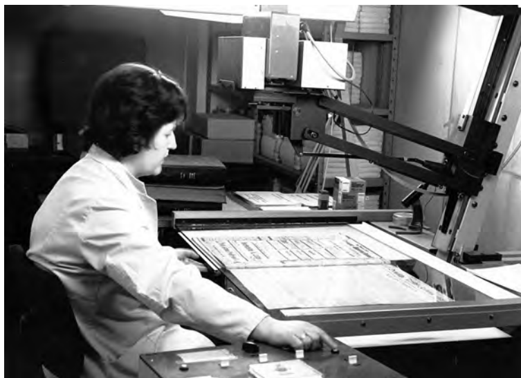
Mikrofilmaufnahme im Vollschrittmodus, ALVR: Foto Pressestelle des LVR 1967
