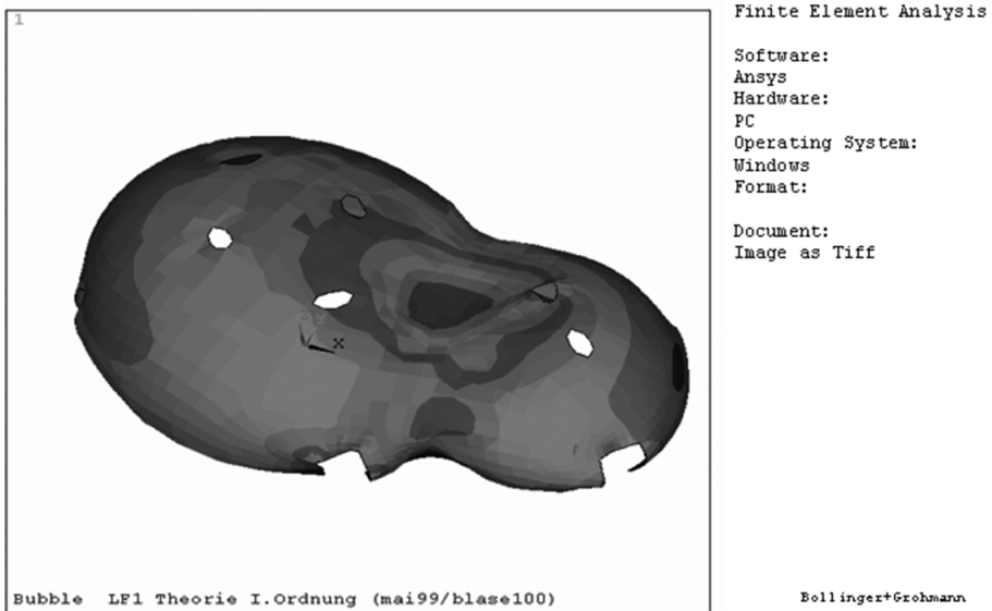
Abb. 12: Bollinger+Grohmann, BMW Bubble, Berechnung der Außenhaut, Software Ansys, Hardware PC, Operating System Windows, Quelle: Deutsches Architekturmuseum, Frankfurt.
