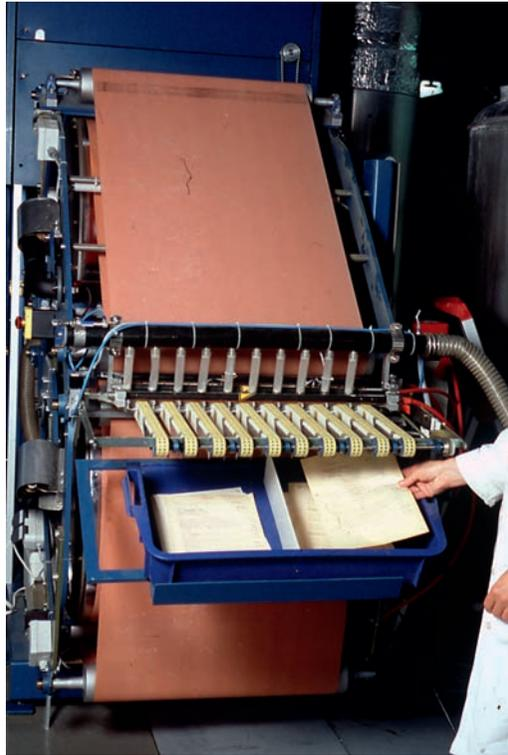
Abb. 7: Prototyp der ersten Einzelblattentsäuerungsanlage: Schlussstrocknung/Glättung und Papierausgabe.
