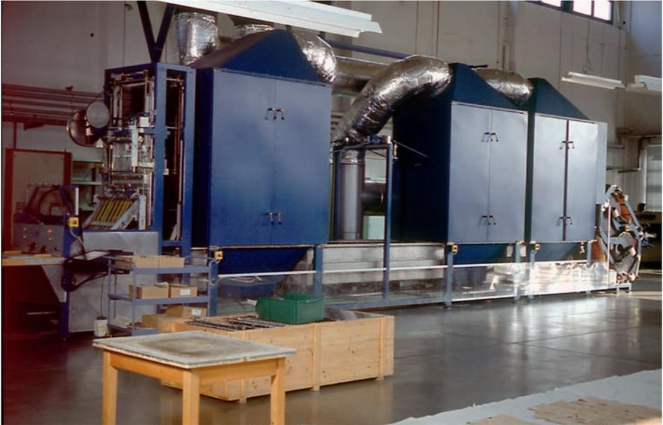
Abb. 2: Prototyp der ersten Einzelblattentsäuerungsanlage: Gesamtansicht von schräg vorn.
