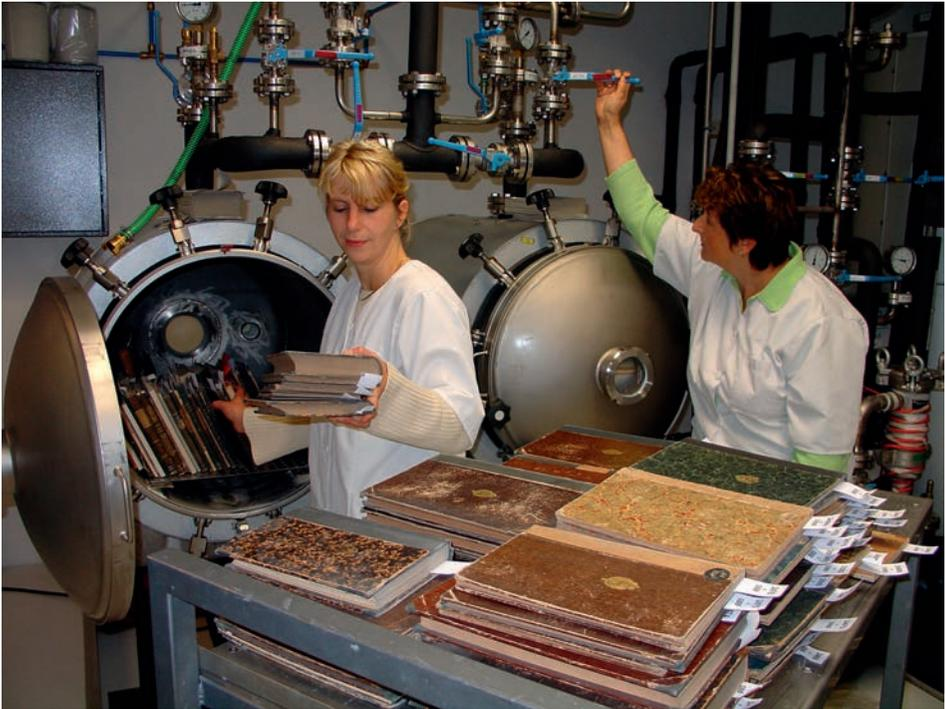
Abb. 12: Stationäre Anlage der PAL zur Entsäuerung nach dem CSC-BookSaver-Verfahren.
