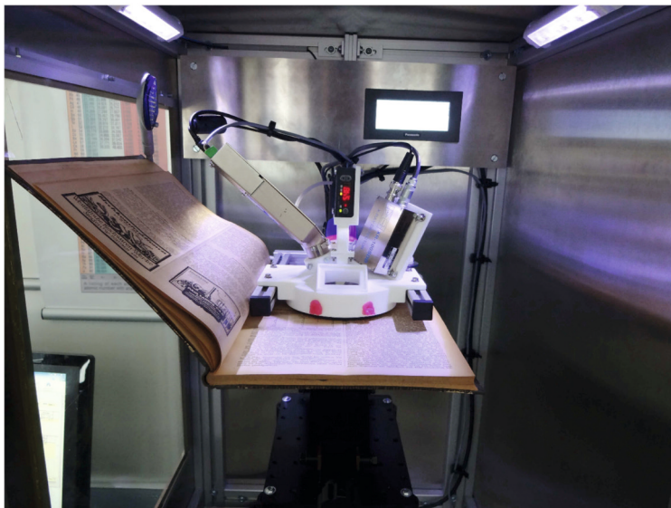
Abbildung 5: XRF-Messmethode der HsH zum Nachweis der Ausreinigungsfähigkeit.
